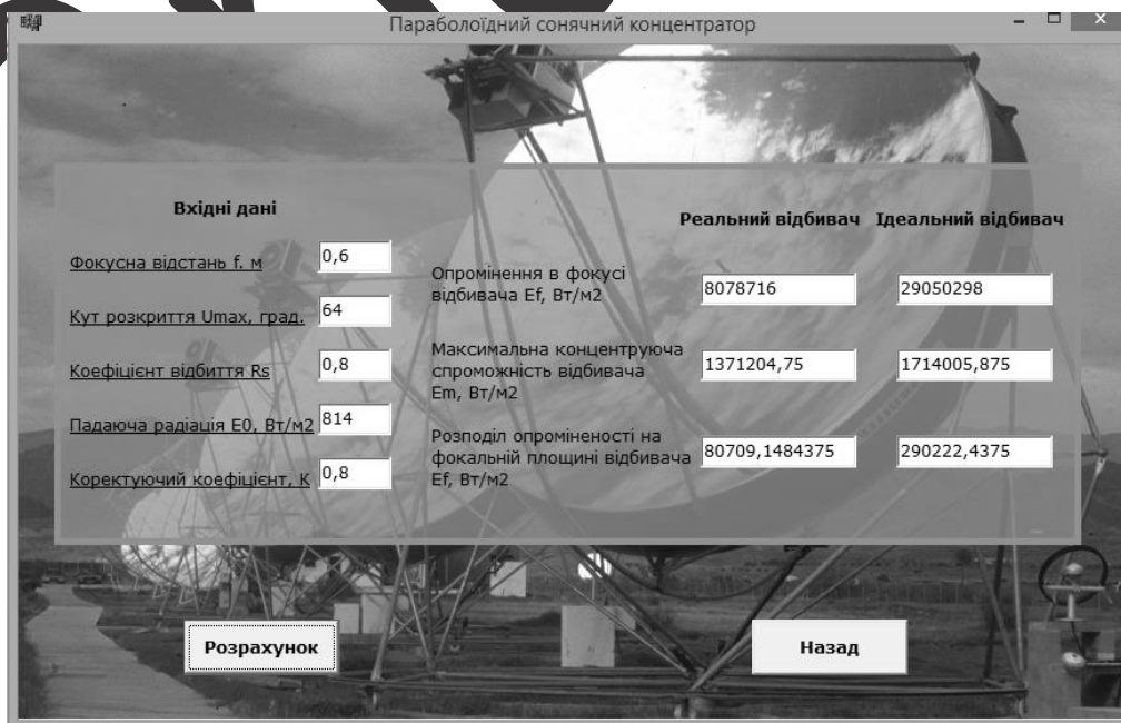
Рис. 6. Програма розрахунку параболоїдного сонячного концентратора
